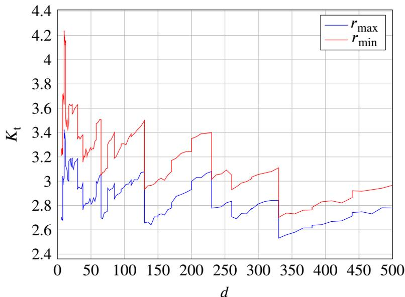
轴径较小时键槽的宽度和深度相对较大，所以应力集中系数也较大，而宽度和深度是阶梯状变化的，所以数据会出现跳变。键槽的圆角较大时，应力集中系数较低。进一步的分析表明，其他条件相同的情况下， $1/K_t$  与圆角半径近似成线性关系，所以两条曲线的形状很相似，像是同一条曲线变换而成。圆角半径取中间的值时，可以利用  $1/K_t$  进行线性插值，得到应力集中系数的值。
