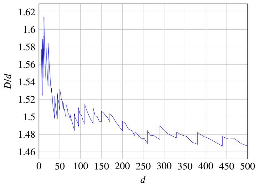
可以看到，数据有很强的波动，但大体的趋势是随轴径增大而减小。锯齿形的顶点一般正是在键槽尺寸刚进入下一阶段时。如果只通过这些极大点做拟合，结果会太过保守，毕竟一般不会采用这样的轴径。下图中轴径只在优先数系中取值，数据的波动不那么强，数值也显得略低。
