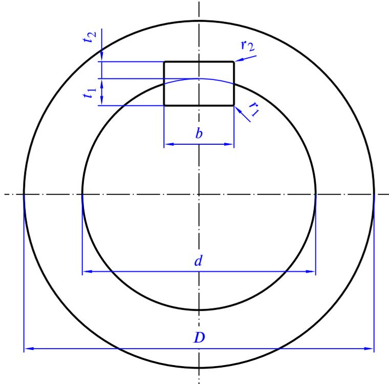
带键槽的轴与毂的截面如上图，尺寸一般按标准确定。我国的平键标准是米制单位下通行的标准，本文就针对此标准进行分析。标准对直径6–500 mm 的轴规定了平键和键槽的尺寸。平键截面的高度  $h$  在宽度  $b \leq 6$  时与之相等，随着  $b$  增大， $h/b$  很快降至约 0.6，而后逐渐降至 0.5。键的宽度随轴径以阶梯的形式变化，总的趋势是与轴径的比值随轴径的增大减小。 $b/d$  在 0.42–0.2 之间。键槽深度  $t_1$ 、 $t_2$  的取值在于使得轴和毂与键的接触高度接近。 $t_1 + t_2$  略大于  $h$ ，留有间隙。 $t_1/d$  在 0.25–0.06 之间， $t_2/d$  在 0.19–0.04 之间。标准中对键槽圆角给出的是一个范围，与  $h$  最为相关， $r_{\min}/h$  在 0.05–0.02 之间， $r_{\max}/h$  在 0.08–0.03 之间。
