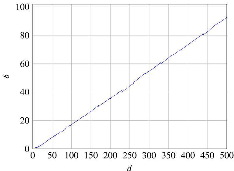
下面的图将上图左下角局部放大，锯齿形波动才更容易看到。和前一小节不同，锯齿形的顶点往往是在每个阶段的最后，键槽的尺寸在下一阶段增大，需要的壁厚反而稍微减小。又可以看出，20 以内的数据线性关系不是那么强，而且变化的趋势与轴径更大时相比更为平缓。
